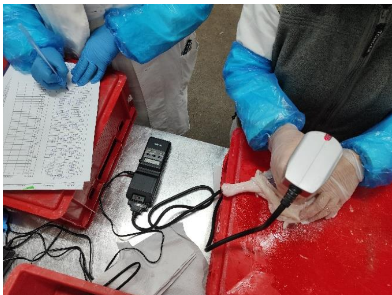
Ryc. 9. Pomiar pH mięsa gęśiego i rejestracja wyników podczas badań (Autor zdjęcia: Patrycja Dobrzyńska).
